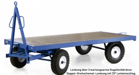
Lenkung über 2 wartungsarme Kugelenkränze Doppel-Drehschemel-Lenkung mit 35° Lenkeinschlag
