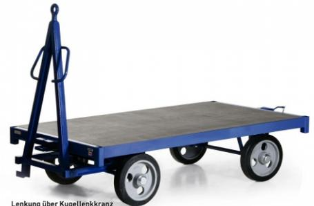
Lenkung über Kugellenkranz
