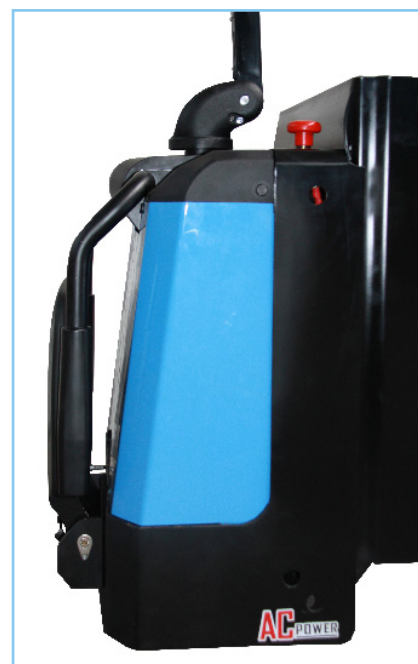
Enganliegend lassen sich Seitenbügel und Plattform bei Nichtbedarf einklappen
